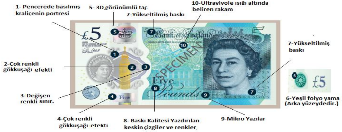
Şekil 1. İngiltere Plastik Banknot Güvenlik Unsurları
